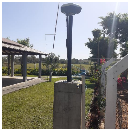
Antena e pilar
