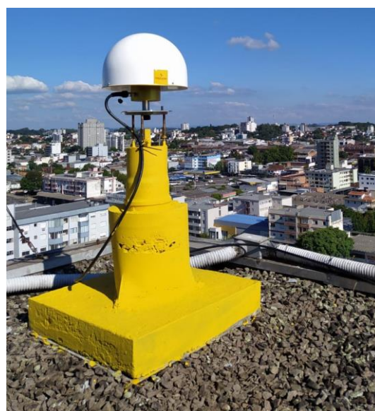
Antena e pilar
