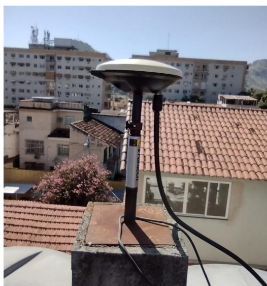
Antena e pilar
